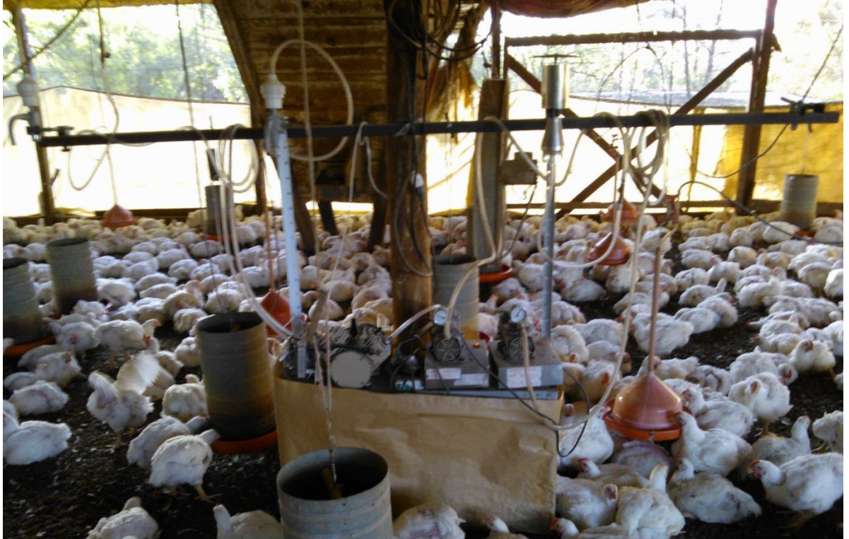
Figura 19 – Imagem do conjunto montado para amostragem na granja de frangos de corte. Da esquerda para direita, coletores MP 1,0 , MP 2,5 , MP 10 e impactador Sioutas
