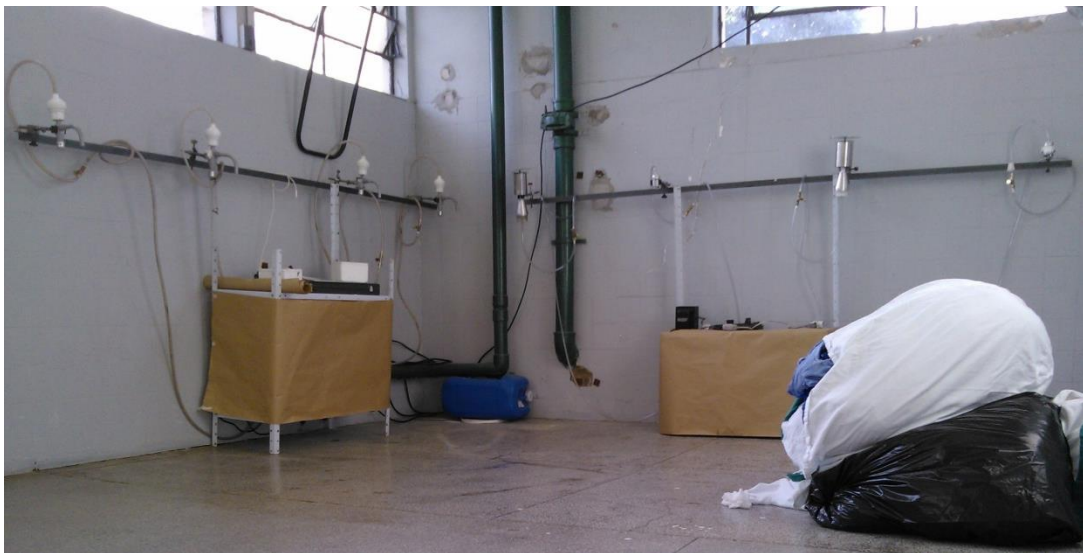
Figura 18 – Imagem da montagem dos dois conjuntos usados para amostragem na “área suja” da lavanderia do HU. Lado esquerdo: da esquerda para a direita coletores; MP 1,0 A, MP 2,5 A, MP 1,0 B e MP 2,5 B. Lado direito: da esquerda para direita; MP 10 A, impactador Sioutas A, MP 10 B e impactador Sioutas B.
