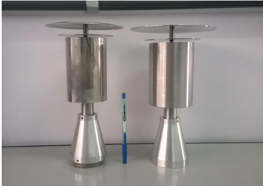
Figura 8 – Imagem dos coletores MP10 Low-vol ZUF – Universidade de Frankfurt – Alemanha
