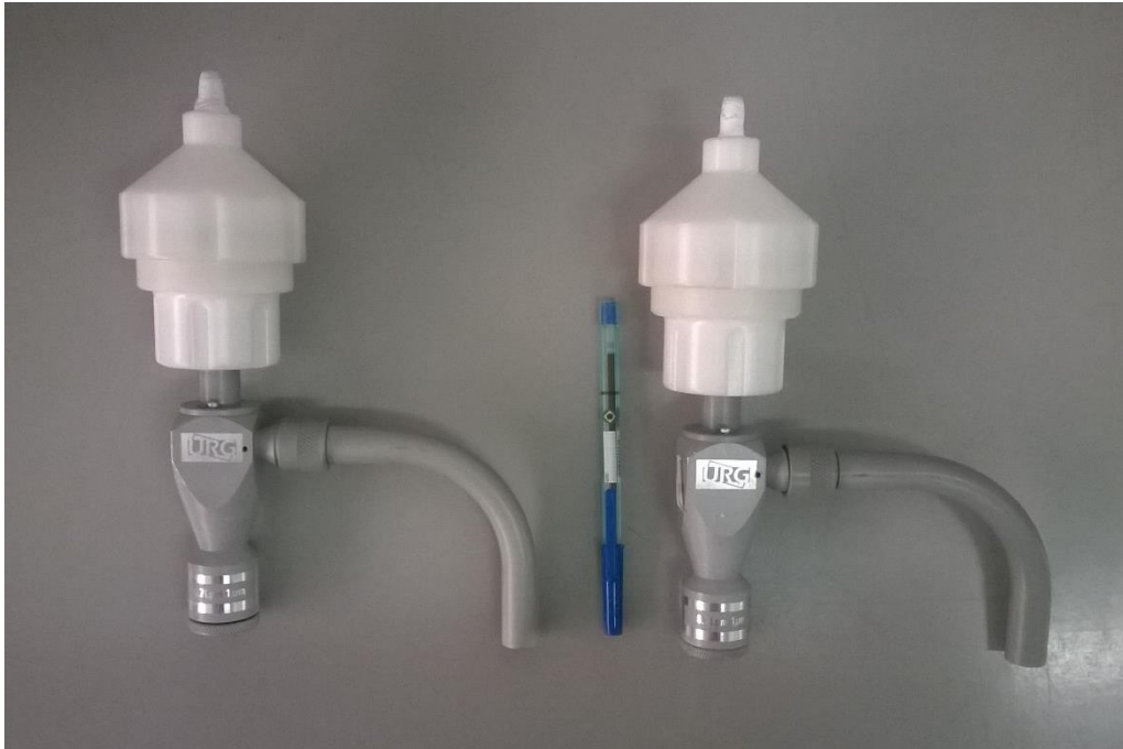
Figura 9 – Imagem dos coletores ciclones Teflon ® Coated Aluminum Cyclones MP 1,0 URG-2000-30EHB
