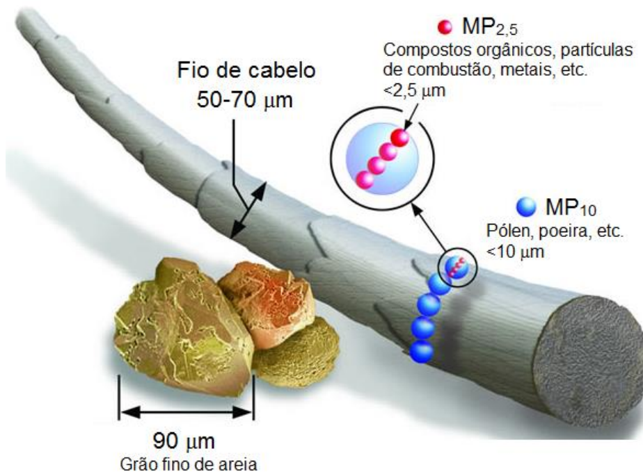
Figura 2 – Representação esquemática do tamanho do material particulado grosso (MP10) e fino (MP2,5)
