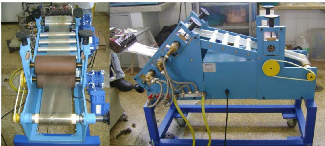
Figura 9 –Funcionamento da calandra para a produção de filmes planos.
