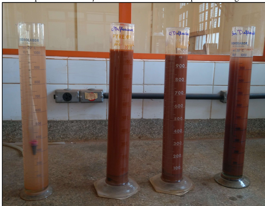
Figura 18 – Etapa de sedimentação com e sem defloculante para análise granulométrica.
