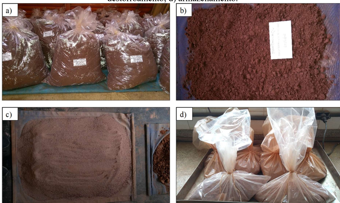
Figura 17 – Principais etapas de preparação do solo: a) coleta; b) secagem ao ar; c) destorroamento; d) armazenamento.
