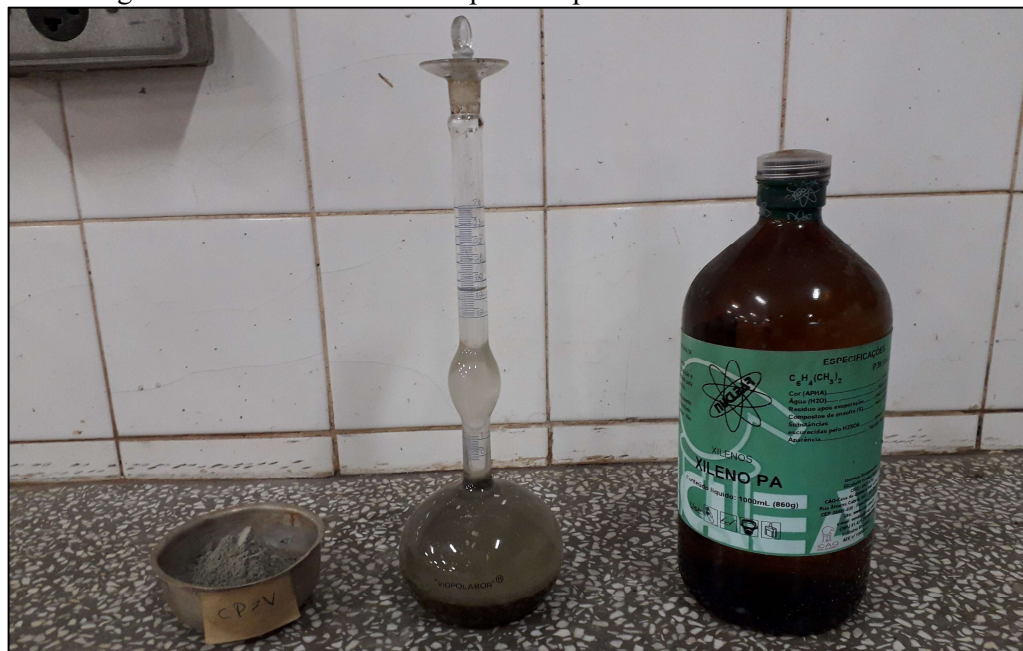
Figura 19 – Ensaio de massa específica para os cimentos CP II e CP V.
