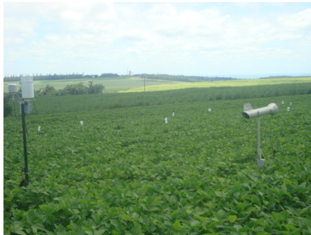
Figura 3.1 – Vista parcial da unidade experimental. À direita, o coletor de esporos, e à esquerda a estação meteorológica automática.
