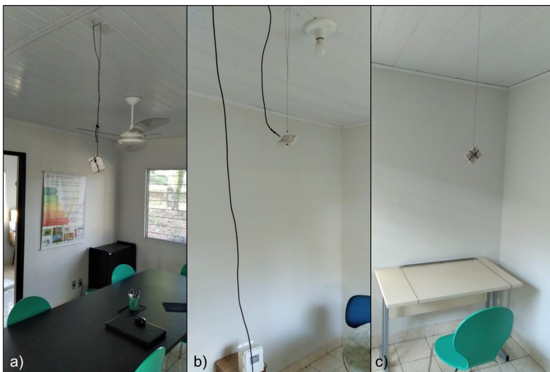
Figura 14 - Medição da temperatura e umidade relativa do ar interno: (a) Sala; (b) Dormitório 1; (c) Dormitório 2.
