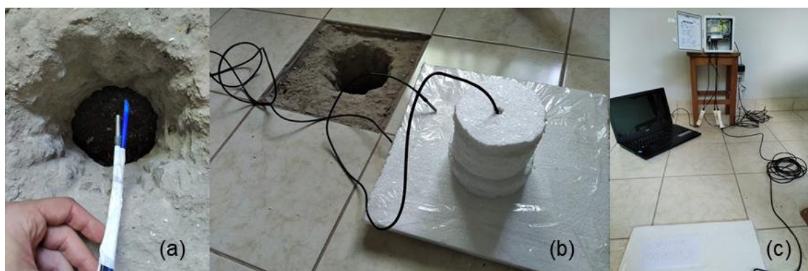
Figura 11 – (a) sensor S-TMB-M006 com haste para facilitar sua inserção sob o piso; (b) furo e tampa de EPS para isolamento; (c) sistema de monitoramento montado com registrador de dados HOBO U30.
