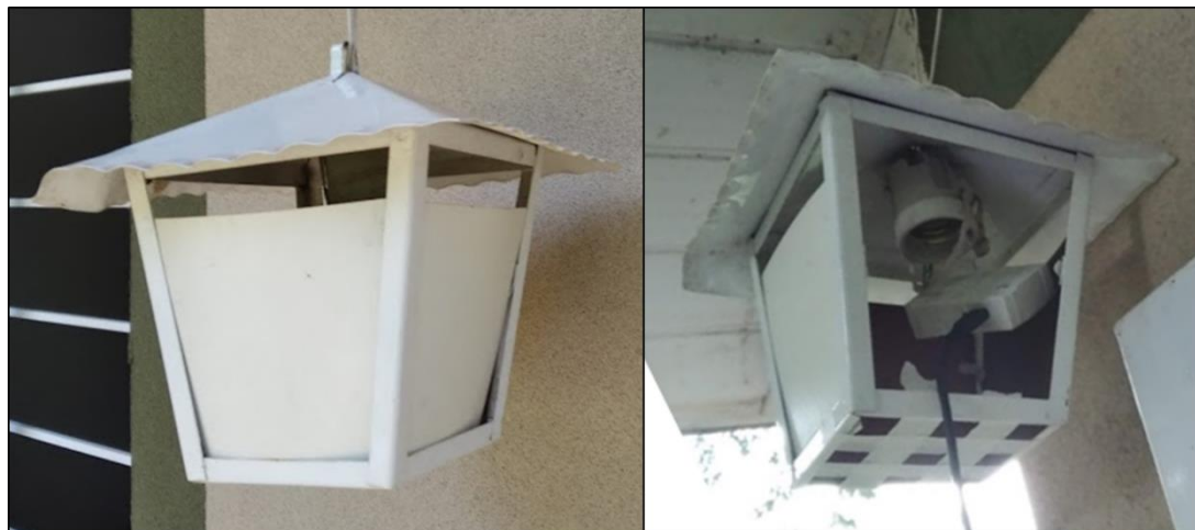
Figura 13 - Detalhe do abrigo para monitoramento externo
