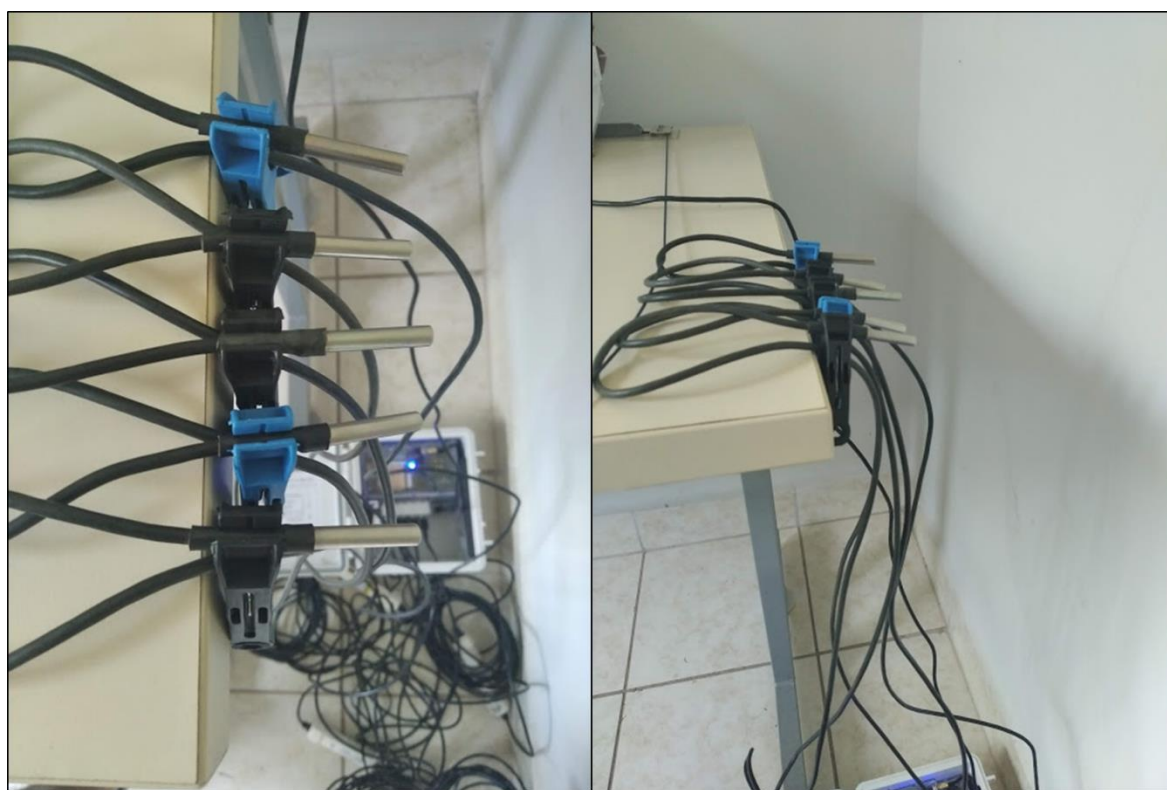
Figura 9 - Teste inicial para verificar discrepância entre os sensores para medição de temperatura do solo
