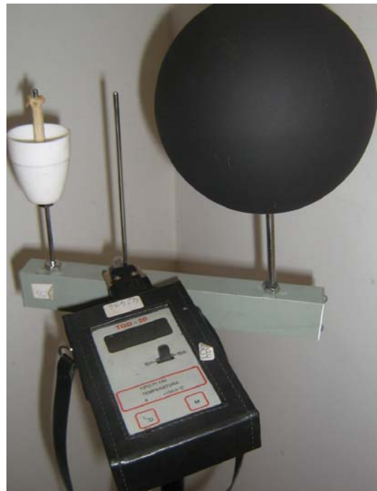
Figura 13 - Termômetro de globo digital da Instrutherm modelo TGD-50 tipo Pt 100.
