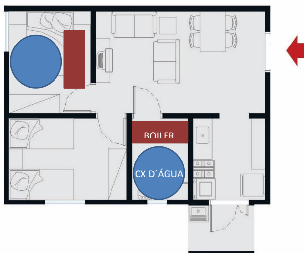
FIGURA 55: Esquema de localização dos reservatórios
