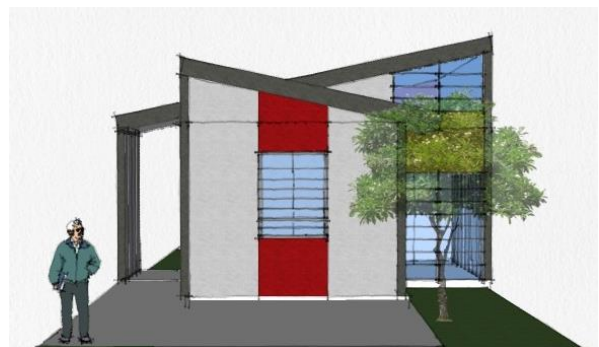
FIGURA 32: Interferência entre módulo base e customização ao permitir o avanço do beiral
