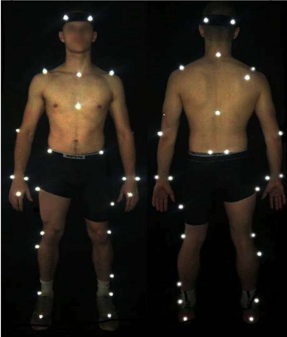
Figura 2. Posicionamento dos marcadores de acordo com o modelo PlugInGait (Full Body) .
