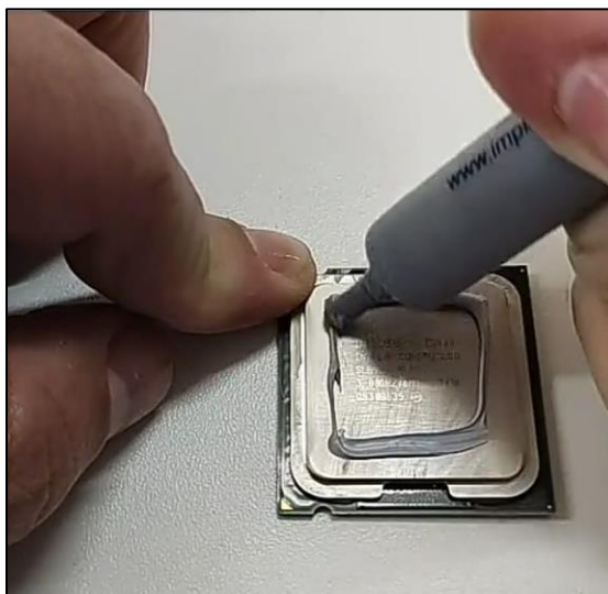
Figura 4.3: Aplicação de pasta isotérmica do laboratório de metrologia
