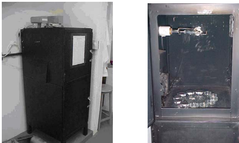
Figura 14. Exposição das amostras à lâmpada a vapor de mercúrio sem vidro protetor.
