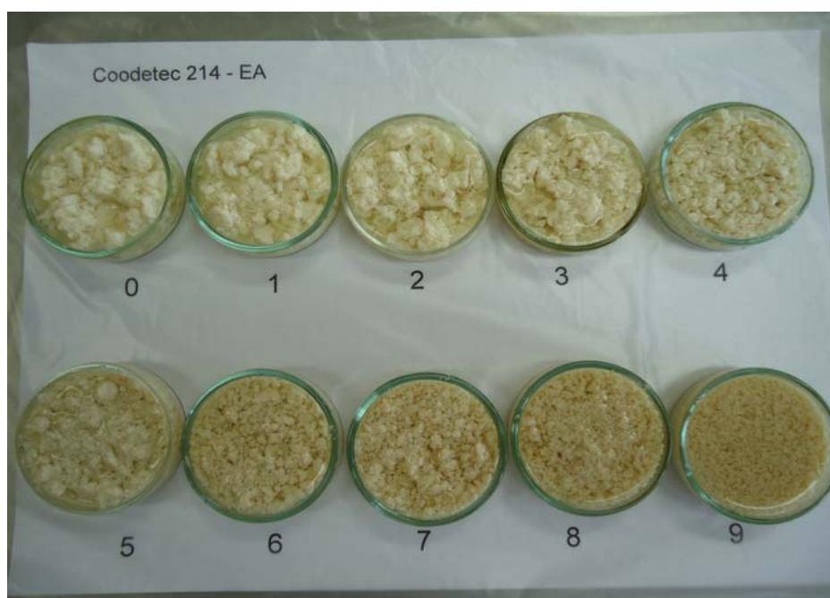
Figura 2 - Coágulo protéico de extrato de soja envelhecida na condição EA (solução coagulante: \text{MgSO}_4 \cdot 7\text{H}_2\text{O} 20%)
