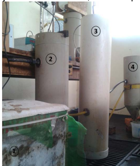
Figura 9 - Sistema biológico utilizado após o 244º dia de operação, com ênfase para a mudança do reator aeróbio, indicado pelo número 3.
