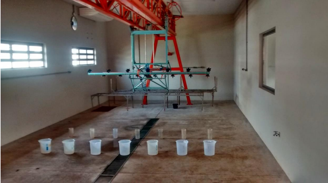
Figura 2 – Equipamento automatizado utilizado para a simulação de volumes de precipitações pluviais.
