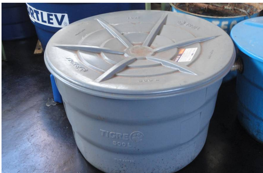
Figura 4.3 - Caixa de 500 L utilizada armazenamento de lixiviado tratado biologicamente.
