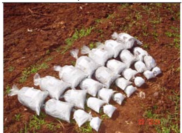
Figura 36 – Acondicionamento do solo em sacos plásticos etiquetados devidamente
