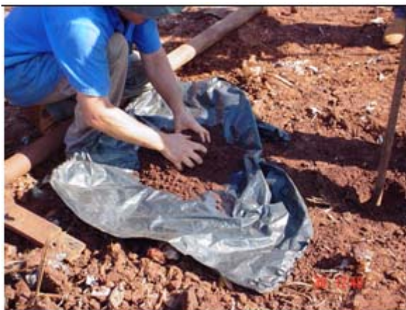
Figura 35 – Homogeneização das amostras de solo
