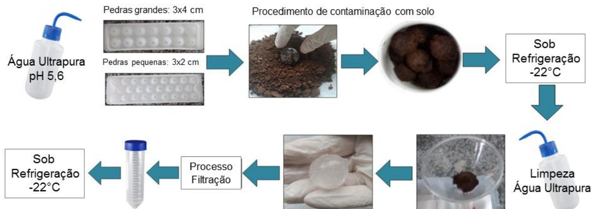
Figura 17 - Fluxograma do procedimento de limpeza dos granizos. Produção de pedras de granizo, contaminação com solo, armazenamento, lavagem, filtração e armazenamento.
