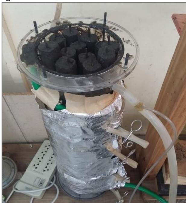
Figura 9 - Preenchimento do reator anaeróbio
