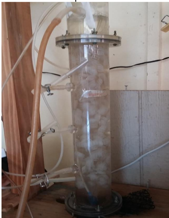
Figura 10 - Reator aeróbio preenchido com material suporte
