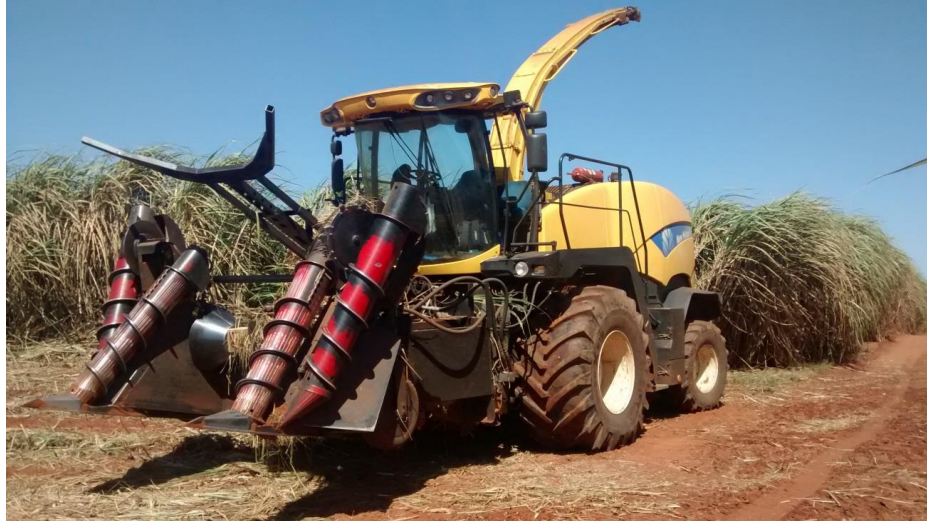
Figura 4. Máquina forrageira da New Holland (modelo FR 9060) adaptada para colheita de cana integral.
