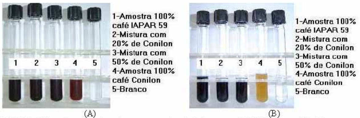
FIGURA V.2 – Cores relativas às reações colorimétricas com HCl (A) e com KI (B) para café arábica, conilon e misturas.
