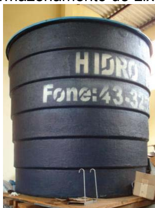
Figura 4 – Tanque de Armazenamento de Lixiviado de Aterro Sanitário
