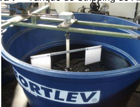
Figura 7 – Tanque de Stripping de Amônia
