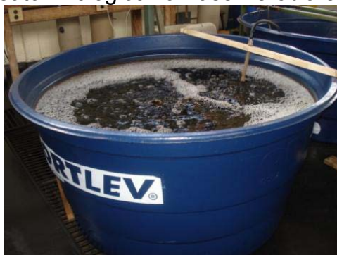
Figura 8 – Reator Biológico na Fase Aeróbia e Fase Anóxica
