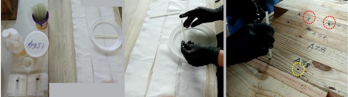
Figura 53: Processo de preparação das cavilhas para inserção nos furos dos painéis.
