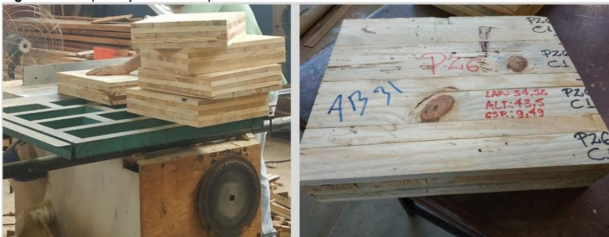
Figura 76: Esquadreamento dos painéis.
