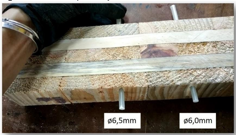
Figura 50: Teste de pré-furação das cavilhas de GFRP.
