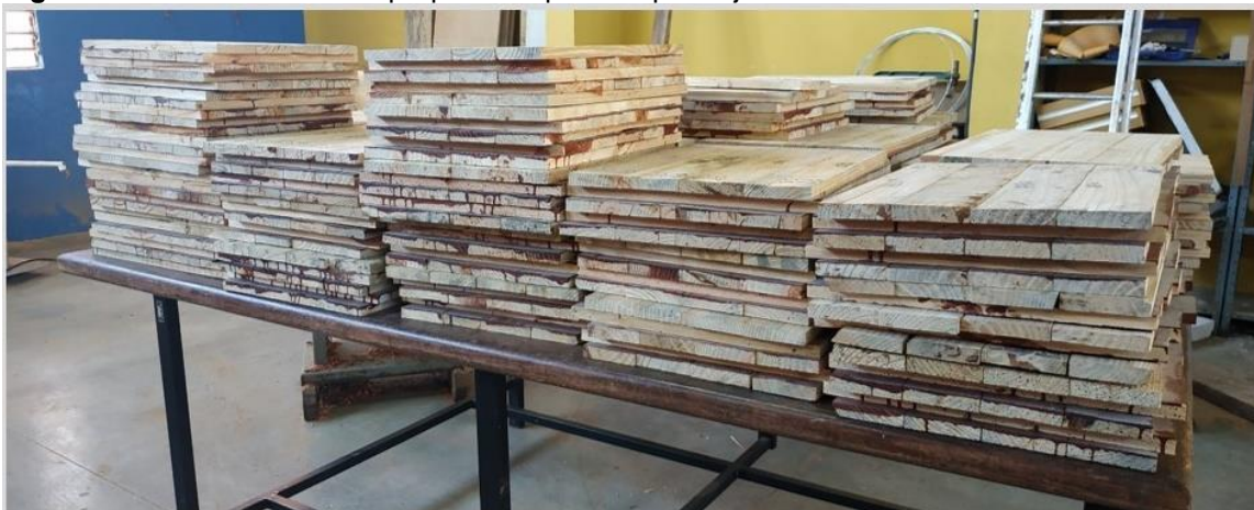
Figura 75: Painéis colados e preparados para esquadramento.
