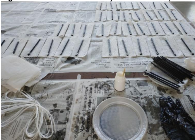
Figura 48: Processo de confecção das cavilhas para ensaio de ligação.
