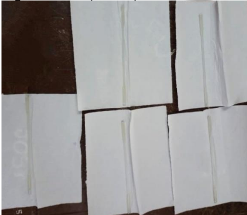
Figura 43: Corpos de prova selecionados para ensaio final de caracterização das cavilhas de GFRP.
