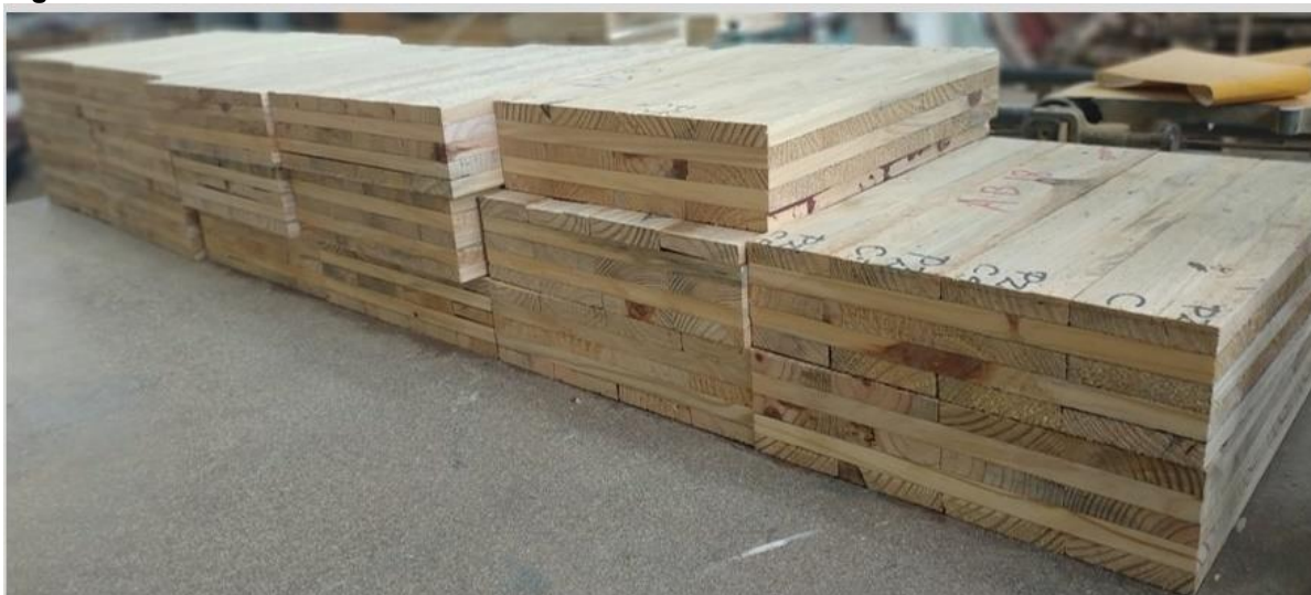
Figura 77: Painéis de CLT concluídos.
