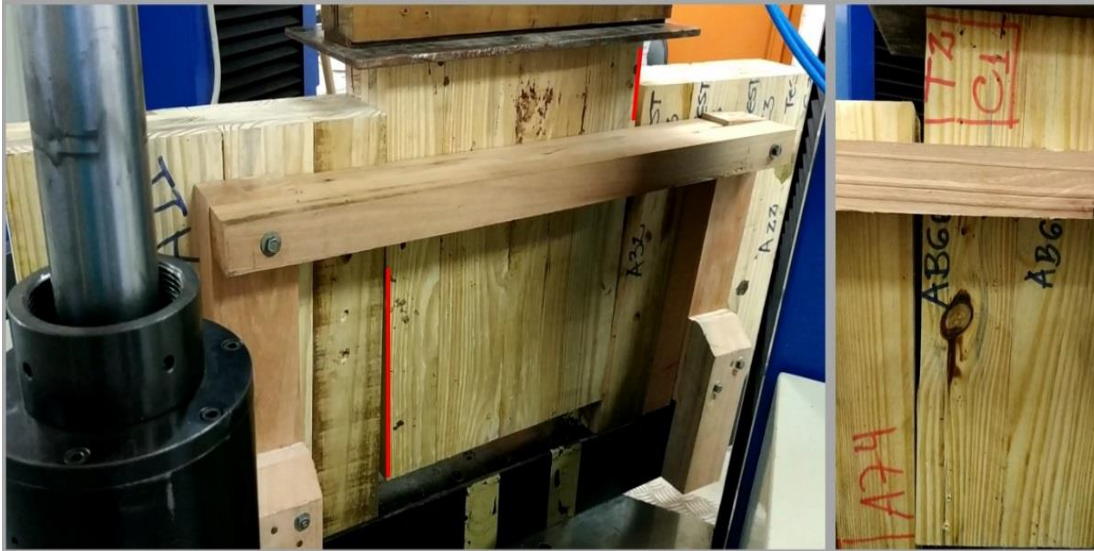
Figura 62: Abertura lateral dos painéis no ensaio.
