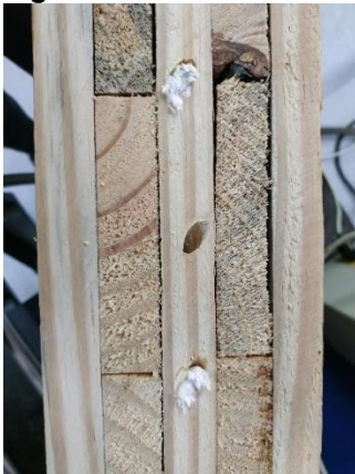
Figura 71: Cisalhamento das ligações posterior aos ensaios.
