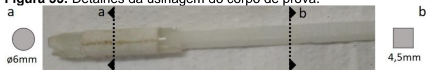
Figura 35: Detalhes da usinagem do corpo de prova.
