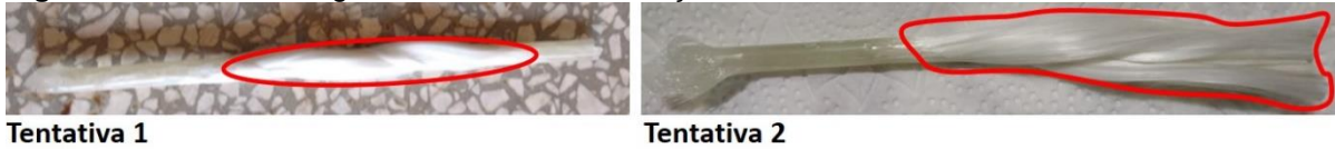
Figura 28: Primeira e segunda tentativa de confecção da cavilha de GFRP.
