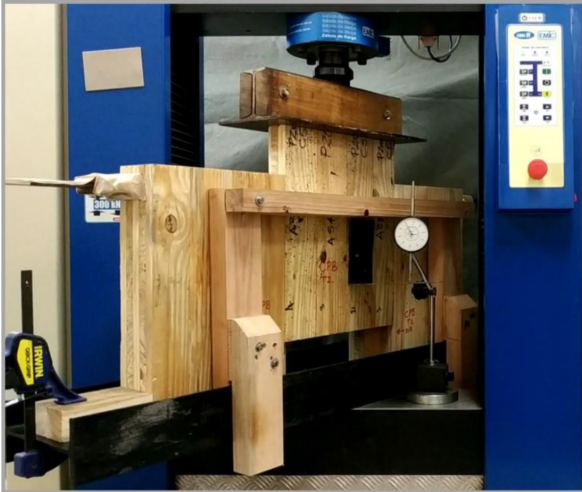
Figura 64: Configuração do ensaio das juntas half-lap .
