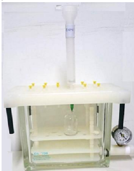
Figura 12. Sistema manifold a vácuo utilizado na otimização do protocolo MISPE para extração de IMT.
