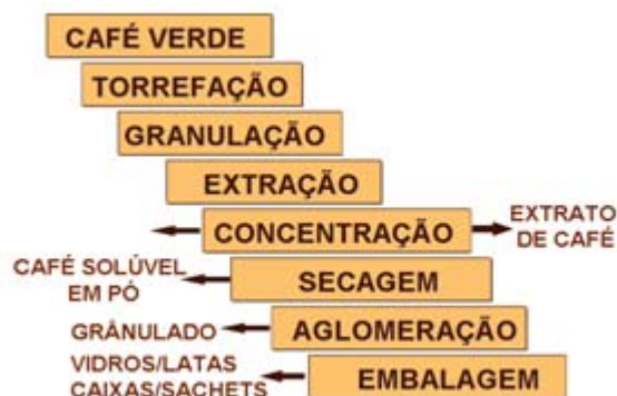
Figura 1 – Fluxograma do processo de café solúvel
