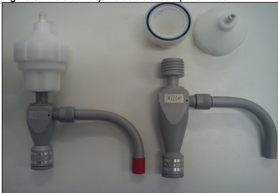
Figura 5 – Foto do conjunto de ciclones e porta-filtros.
