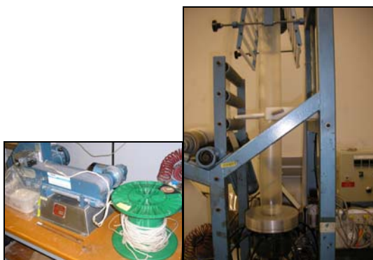
Figura 3.3 – Granulador e extrusora monorosca Axon BX-25 acoplado a uma torre extrusora de filme tubular.
