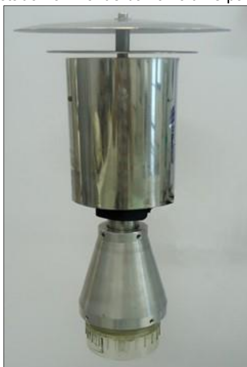
Figura 6 - Impactador low vol de baixo volume para coleta de MP 10
