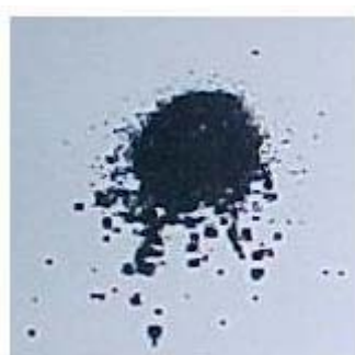
Figura 8 -Resíduo da câmara e pistão de motor que funcionou com gasolina C sem glicerina
