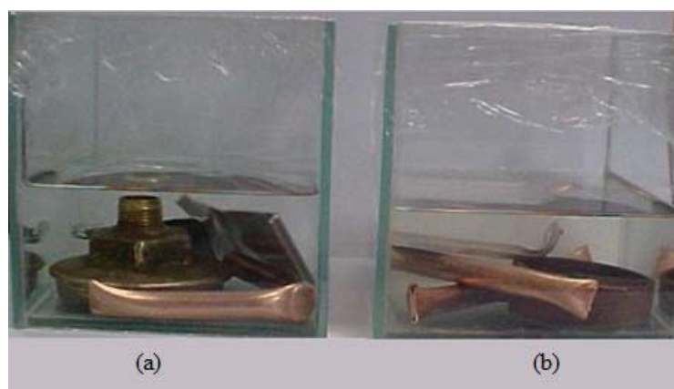
Figura 11 - Primeiro dia de Imersão de metais em misturas de: (a) AEHC/glicerina P.A. 2% (v/v) e (b) AEHC/glicerina loira 2% (v/v)
