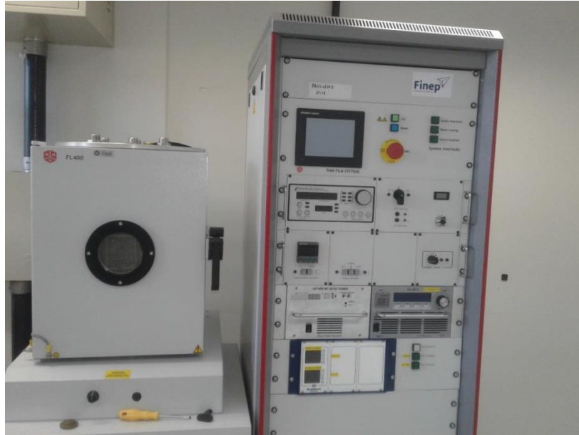
Figura 9: Foto do equipamento de RF Magnetron Sputtering (UEL).
