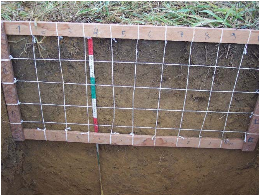
Foto: Parede de uma trincheira com grade para dissecação em área de pastagem cultivada, Brachiaria brizantha de 3 - 4 anos de idade.
