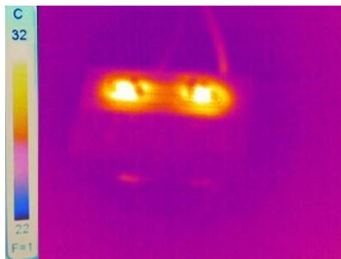
Figura 5.4: Imagem térmica DPHP com raio de 6 mm
