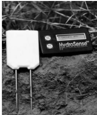
Figura 2.1: Sensor do tipo TDR
