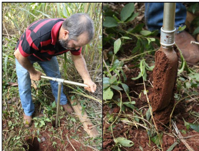
Figura 4: Coleta com o trado
