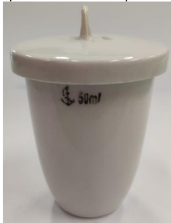
Figura 16 - Cápsula de porcelana com tampa utilizada para pirólise de BC
