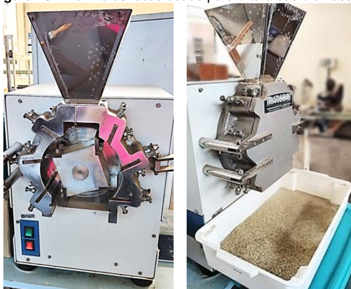
Figura 15 - Moinho de facas usado para tritura das biomassas
