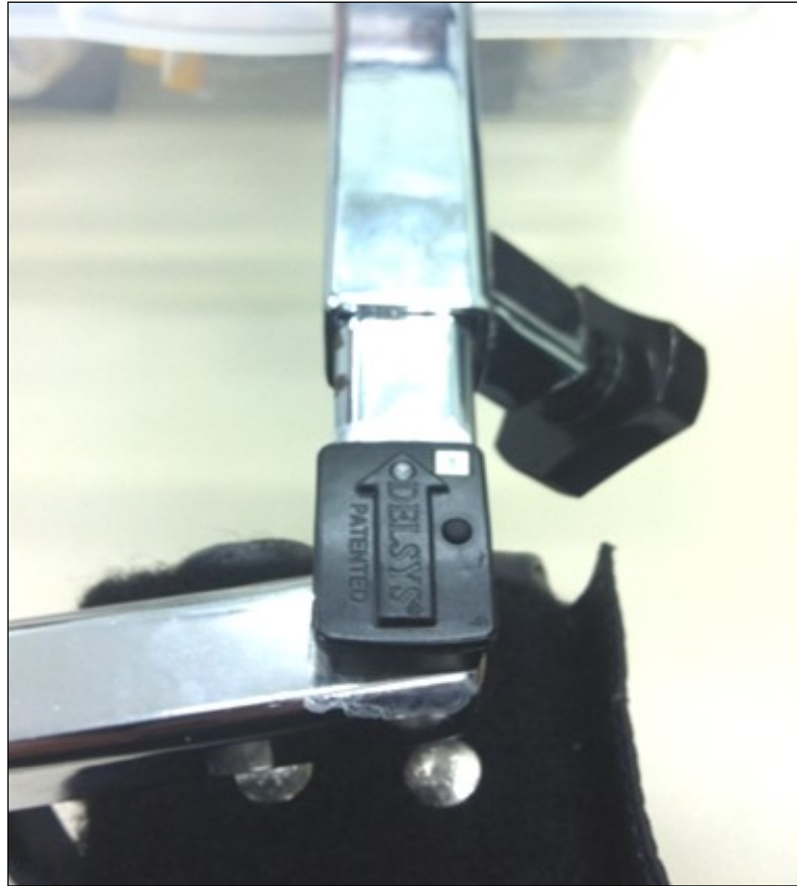
Figura 17 - Posição do eletrodo com acelerômetro fixado na alavanca do dinamômetro (Fonte: o autor).
