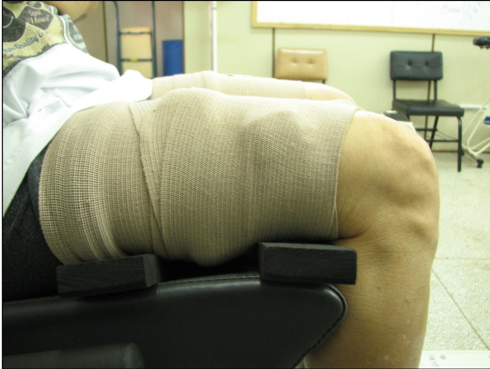
Figura 15 - Posicionamento das tiras de EVA abaixo da coxa para minimizar o contato dos eletrodos de EMGs dos músculos flexores com a cadeira do dinamômetro (Fonte: o autor).
