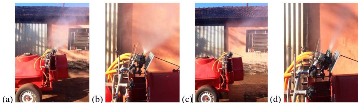
Figura 2. Pulverizador com a configuração do jato de ar e barra inclinados em 30° em relação a vertical. Pontas de jato cônico (a e b); e pontas de jato leque (c e d).
