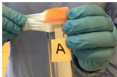
Figura 1B. Vedação dos tubos com fita parafilme.
