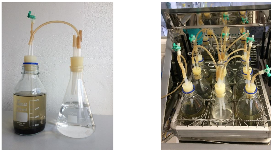
Figura 9 – Aparato experimental utilizado nos ensaios de DQO inerte
