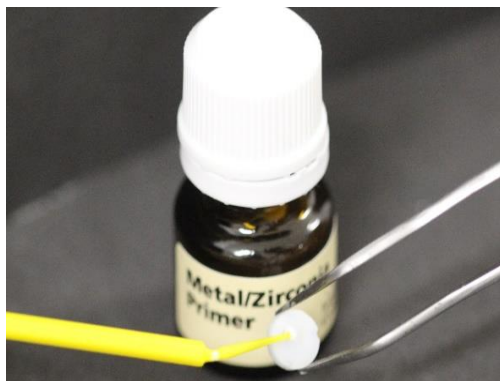
Figura 13 – Aplicação do Metal Zircônia na pastilha.
