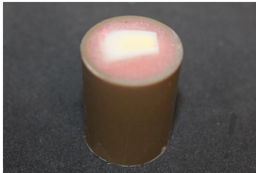
Figura 7 – Cano PVC com a vestibular de incisivo bovino posicionado centralmente para cima e preenchido por resina acrílica rosa auto polimerizável
