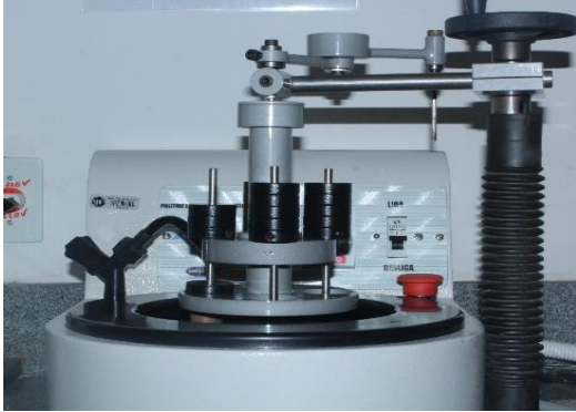
Figura 8 – Amostra levada na Politriz Lixadeira Metalográfica PVV para exposição de dentina
