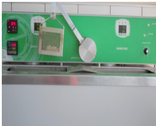
Figura 18 – Pastilhas dispostas na cesta da termocicladora executando oscilação entre banho quente e frio
