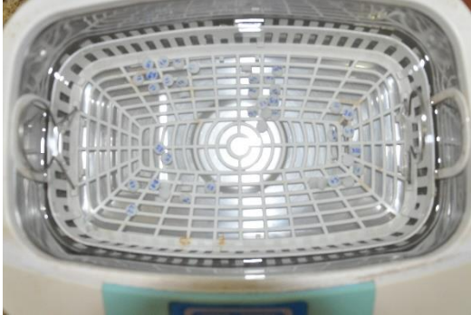
Figura 4 – Aparelho ultrassônico com água destilada e as pastilhas submersas para limpeza
