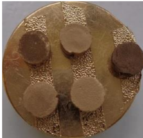
Figura 20 – Pastilhas fixadas em stub , recobertas com ouro e prontas para inserção no microscópio eletrônico de varredura
