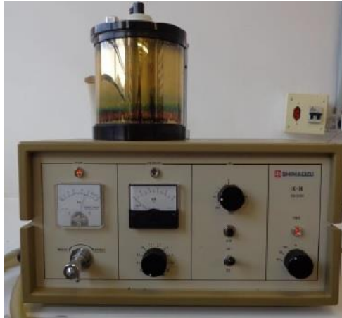
Figura 19 – Metalizadora IC50 para recobrimento com ouro das pastilhas
