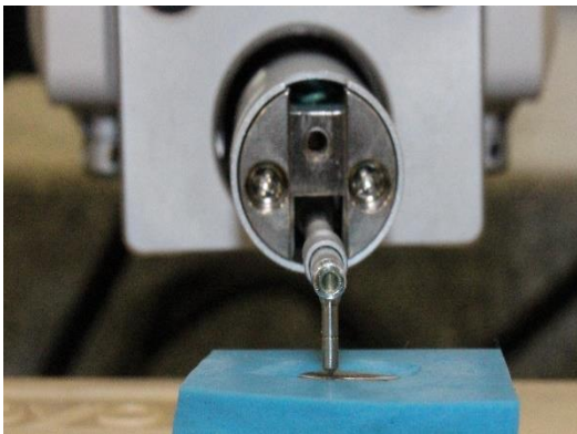
Figura 2 – Suporte de silicone de condensação para acoplar a pastilha e realizar o teste de rugosidade de superfície com os parâmetros estipulados
