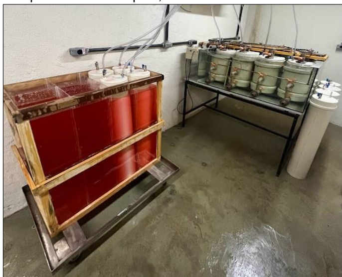
Figura 11: aparato experimental da etapa II, constituído de reatores CSTR e gasômetros.
