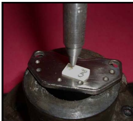
Figura 8 – Teste push out , vista da haste móvel do dispositivo exercendo compressão sobre o cimento retrobturador.
