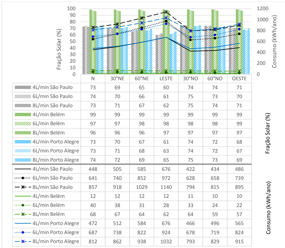
Figura 22 - Impacto do nível de conforto de banho na Fração Solar (%) e no Consumo Anual de Energia (kWh) em condições de limitação da orientação do coletor.
