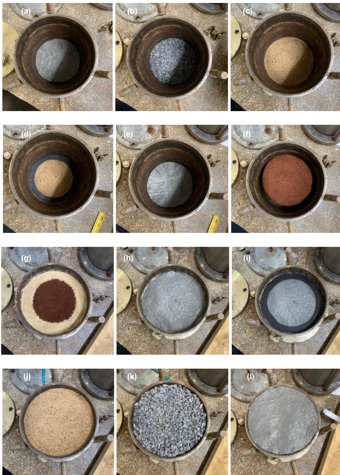
Figura 5.19 – Sequência de montagem do permeâmetro
