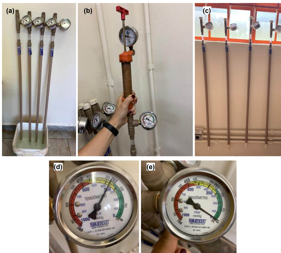
Figura 5.34 – Sequência de calibração dos tensiômetros
