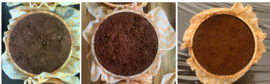
Figura 5.12 – (a) CP no dia da talhagem, (b) 7 dias de secagem e (c) 14 dias de secagem
