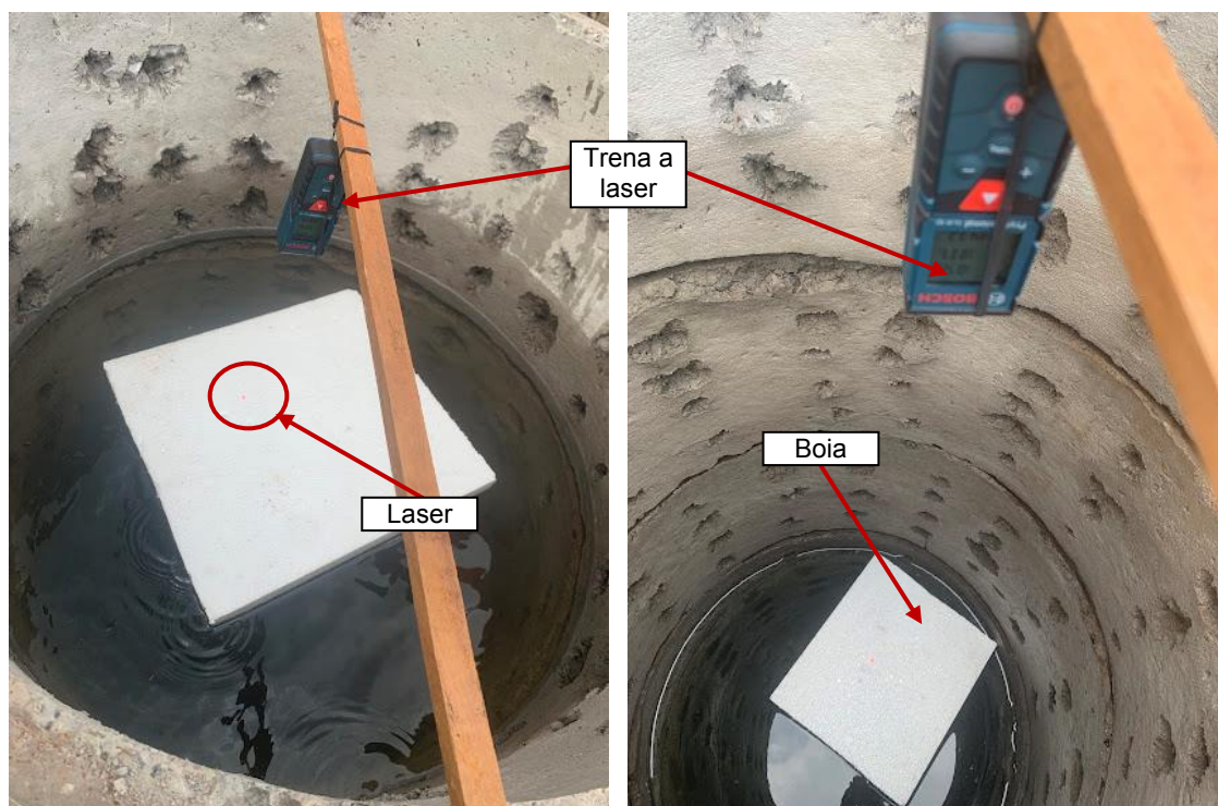
Figura 5.31 – Esquema de montagem da trena a laser e da boia no poço
