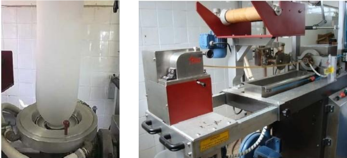
Figura 6 Formação do balão e extrusora mono-rosca utilizada para fabricação de filmes por sopro em balão.
