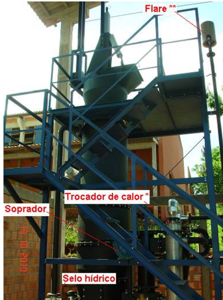
Figura 8 – Gaseificador concorrente de duplo estágio de gaseificação utilizado nos testes
