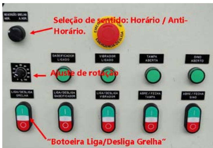
Figura 27 – Acionamento e ajuste de rotação da grelha
