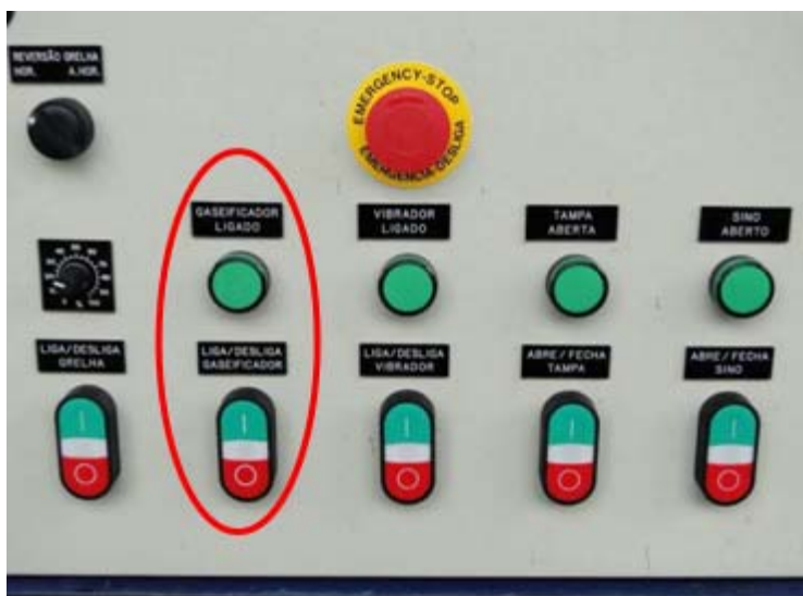
Figura 5 – Botãoeira “Liga/Desliga Gaseificador” - tem a função de ligar/desligar o soprador de ar
