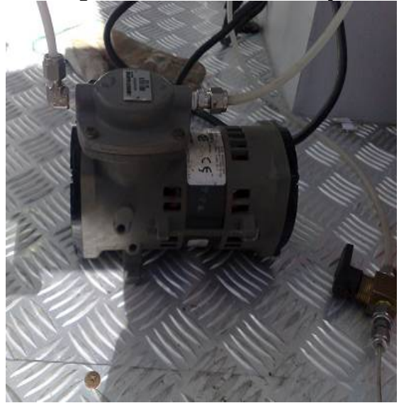
Figura 19 – Bomba de sucção
