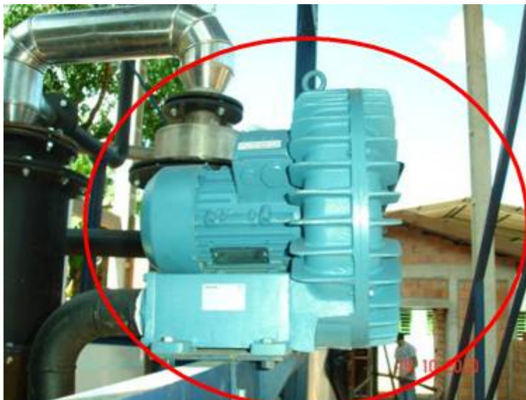
Figura 4 – Soprador de ar: ventilador que injeta ar nos estágios de gaseificação
