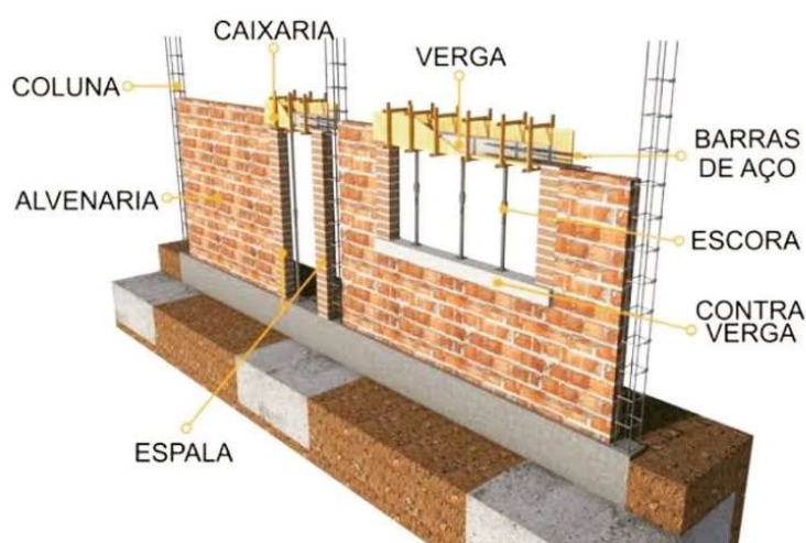
Figura 7 - Elementos da alvenaria convencional
