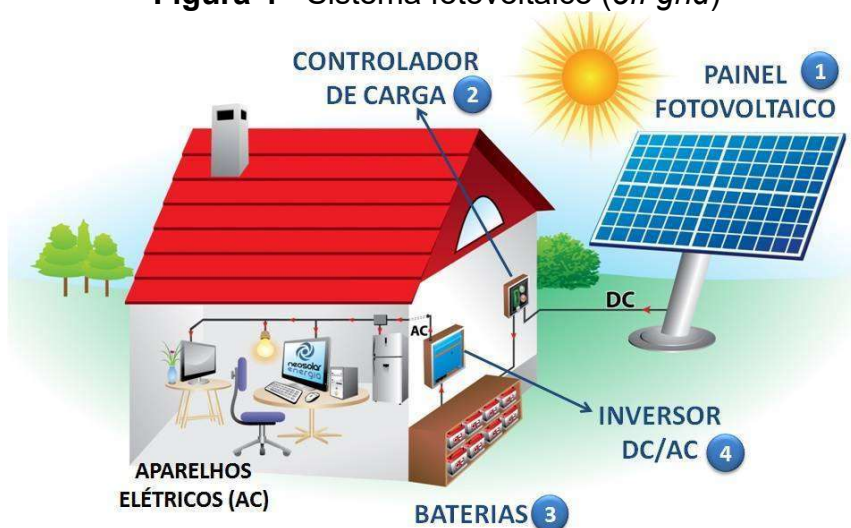
Figura 4 - Sistema fotovoltaico ( off grid )
