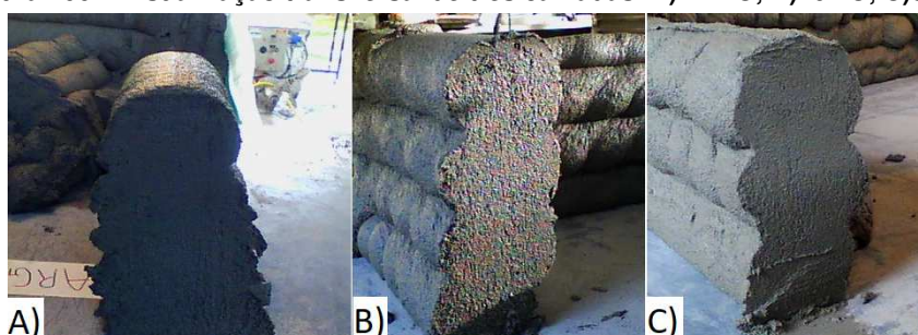
Figura 106 – Visualização transversal de três camadas. A)HPMC; B)10MC; C)30MC.
