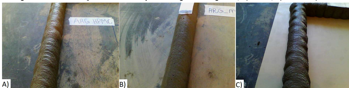
Figura 101 – Visualização das camadas para a imagem termográfica, A) HPMC; B) 10MC e C) 30MC.
