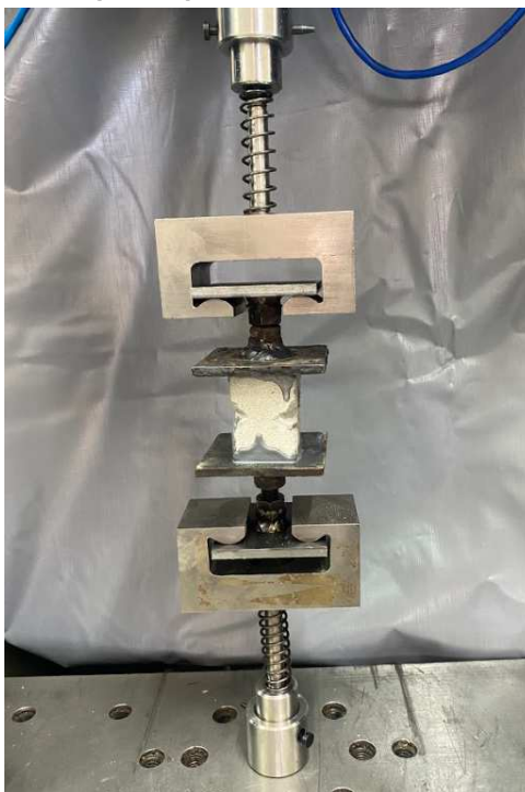
Figura 87 – Amostra pronta para o ensaio de aderência entre camadas
