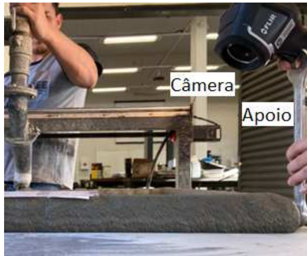
Figura 53 – Câmera termográfica pronta para as imagens de termografia
