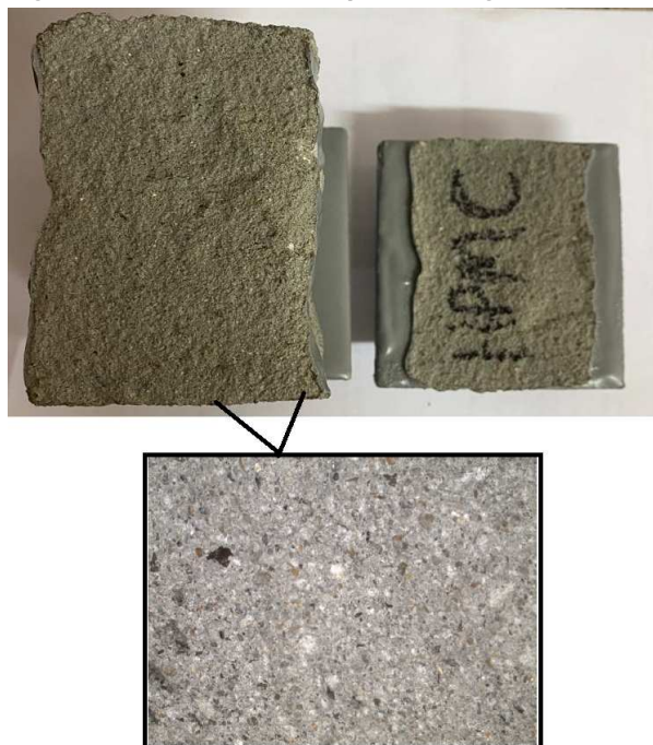
Figura 137 – Interface de ruptura da argamassa HPMC
