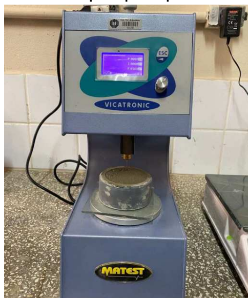
Figura 43 – Equipamento com a pasta pronta para o ensaio de tempos de pega
