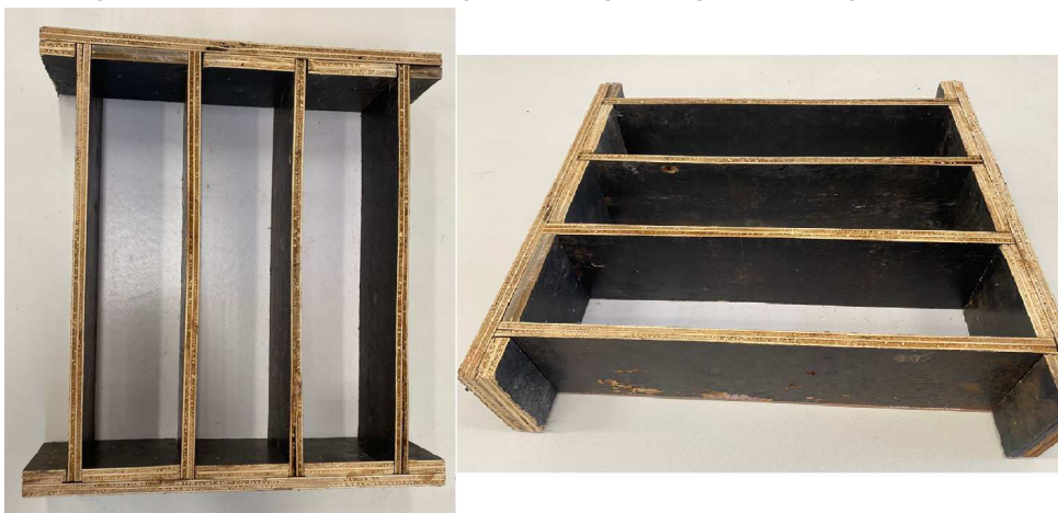
Figura 61 – Fôrmas de madeira para os corpos de prova de tração na flexão
