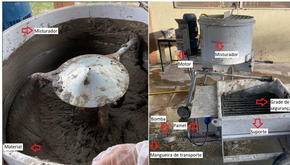
Figura 45 – Misturador e sistema de bombeamento
