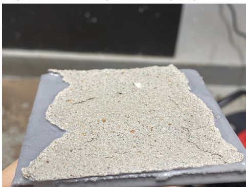
Figura 132 – Rompimento logo após a cola
