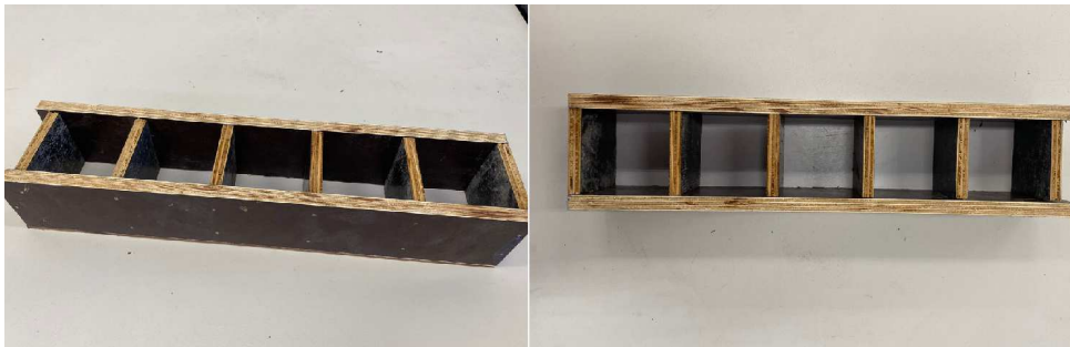
Figura 60 – Fôrmas de madeira para os corpos de prova de compressão
