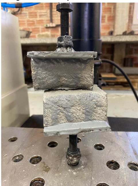
Figura 136 – Rompimento na interface
