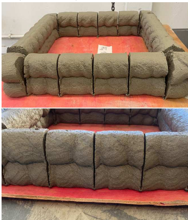
Figura 74 – Corpos de prova cortados para o ensaio de aderência ainda em estado fresco
