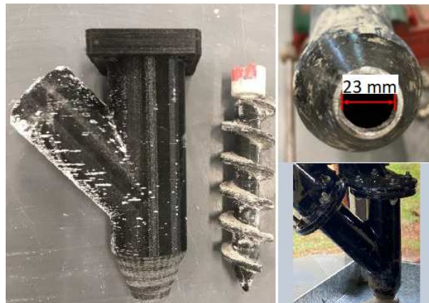
Figura 46 – Mecanismo do bocal da impressora
