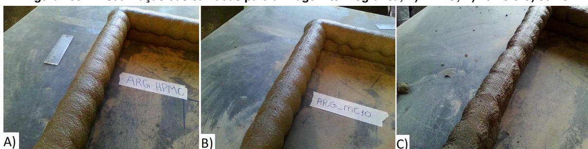
Figura 103 – Visualização das camadas para a imagem termográfica, A) HPMC; B) 10MC e C) 30MC.
