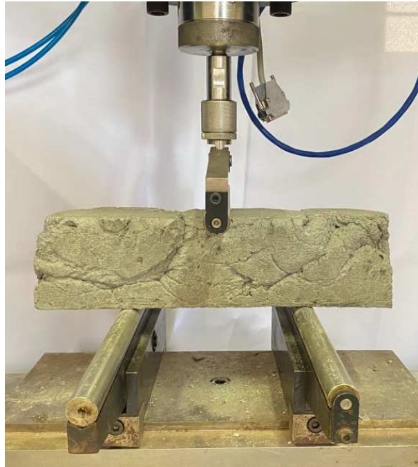
Figura 71 – Amostra impressa e moldada no ensaio de tração na flexão
