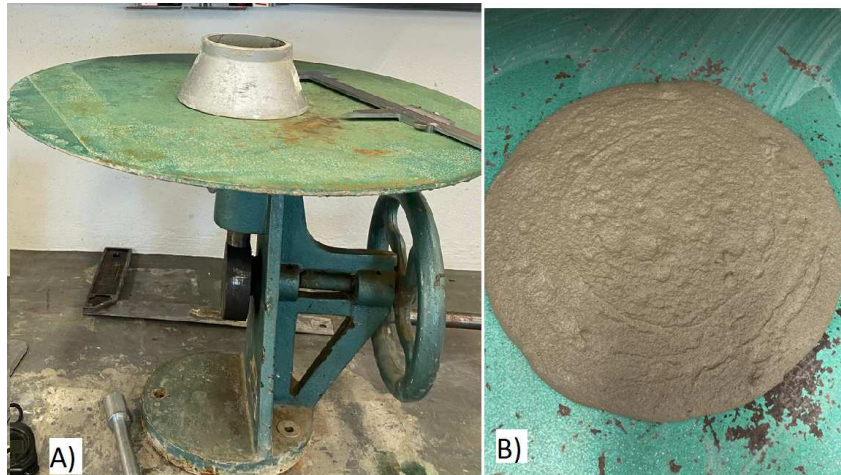
Figura 51 – Equipamentos para o ensaio de consistência A); Argamassa pronta para a medição B).
