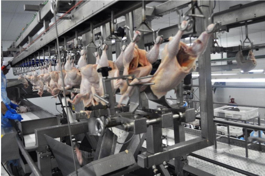
Figura 21 – Sistema modular de corte automático de carcaças de frango
