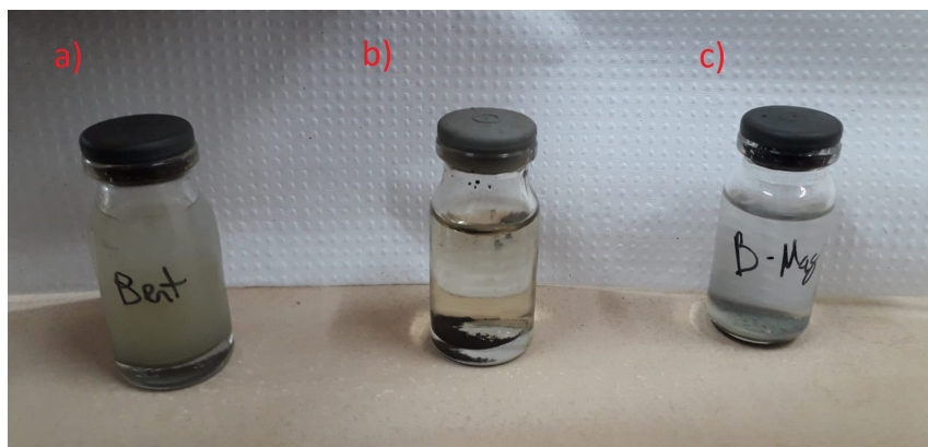
Figura 5.5: Dispersão em água de a) Bentonita, b) Mag-NPR e c) B-Mag; após interação magnética, a bentonita permanece turva e os demais materiais permanecem límpidos
