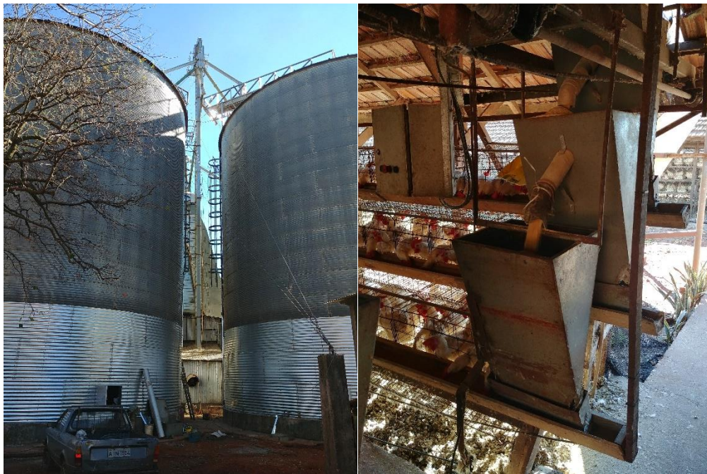
Figura 5 – Silos de armazenamento de grãos e o sistema de distribuição de ração nos galpões de aves (granja B).
