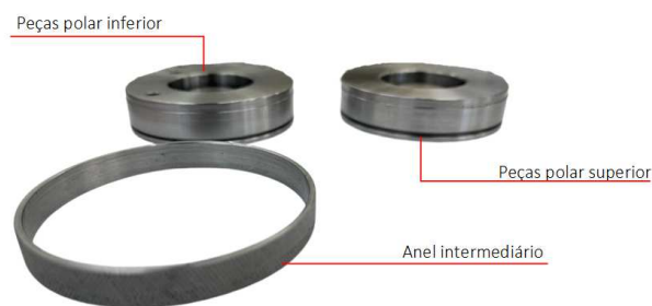
Figura 43: Peças da unidade do acelerômetro usinadas em aço carbono.
