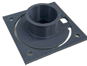
Figura 32: Anel de massa de prova confeccionado em impressora 3D.
