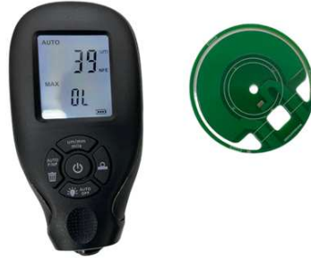
Figura 52: Medição da espessura de tinta.
