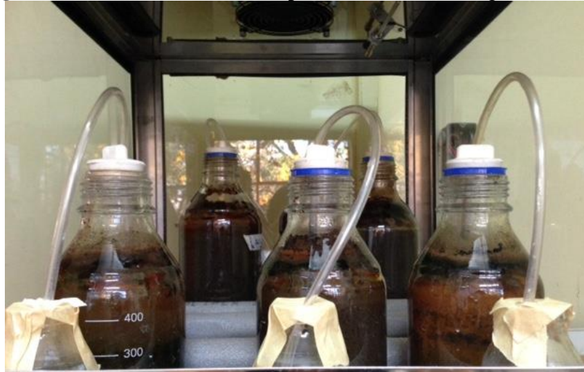
Figura 5 – Shaker com os frascos para os testes de biodegradabilidade.
